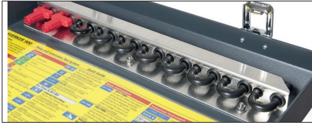
Kapağın içinde tutuculara "park edilmiş" on adet jumper, bir dokunmatik ekran, bir kalem ve hızlı kılavuz bulunmaktadır.
